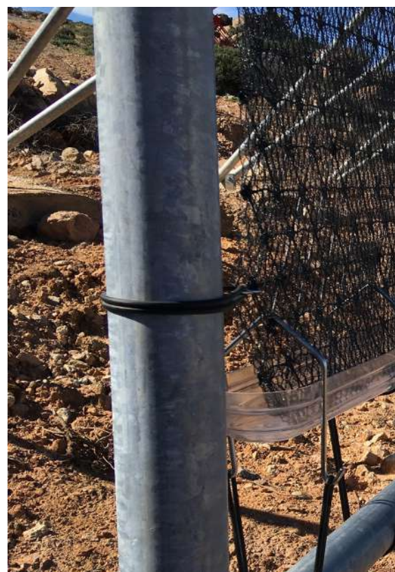
Les capteurs de nuages installés près de Sidi Ifni. Photo C. Partoune.
